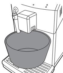
**6** Appuyez sur le bouton CALC CLEAN en le maintenant enfoncé pendant 3 secondes pour lancer le cycle de détartrage. Le voyant du bouton ESPRESSO reste allumé et le voyant du bouton CALC CLEAN clignote tout au long du cycle.
