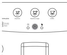
Lorsque le bouton CALC CLEAN reste allumé, vous devez détartrer la machine. Si vous ne détarrez pas la machine lorsque le bouton donne cette indication, la machine cesse de fonctionner correctement. Les réparations ne seront alors plus couvertes par la garantie.
