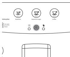
Wanneer de CALC CLEAN-knop onafgebroken brandt, moet u het apparaat ontkalken. Als u het apparaat niet ontkalkt wanneer deze knop dit aangeeft, werkt het apparaat mogelijk niet meer naar behoren. In dat geval vallen reparaties niet onder de garantie.
